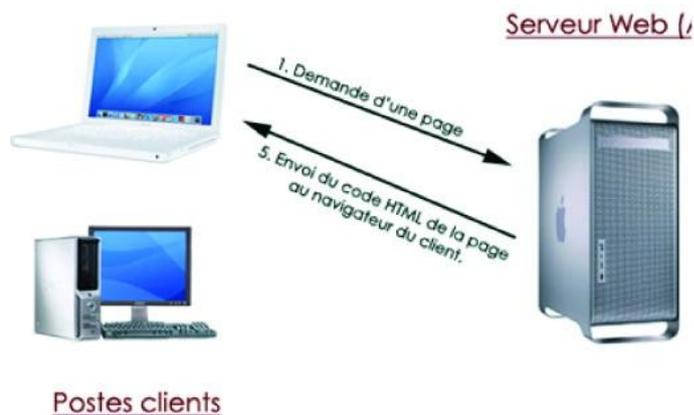
Les services sont exploités par des programmes, appelés programmes clients, s'exécutant sur les machines clientes. On parle ainsi de **client HTTP**, client FTP, client de messagerie, ..., lorsque l'on désigne un programme, tournant sur une machine cliente, capable de traiter des informations qu'il récupère auprès du serveur.
